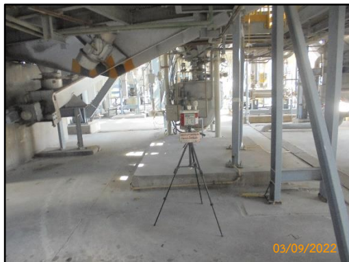
ภาพที่ 3.53 การตรวจวัดความร้อนในสถานประกอบการ บริเวณพื้นที่หม้อไอน้ำ
