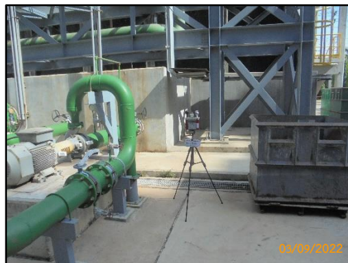
ภาพที่ 3.55 การตรวจวัดความร้อนในสถานประกอบการบริเวณพื้นที่ท่อหล่อเย็น
