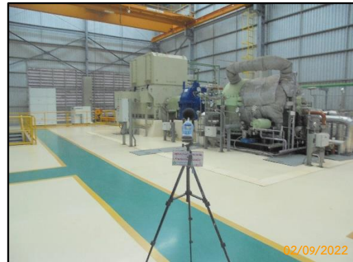
ภาพที่ 3.49 การตรวจวัดระดับเสียงในสถานประกอบการ บริเวณพื้นที่เครื่องกำเนิดไฟฟ้ากังหันไอน้ำ
